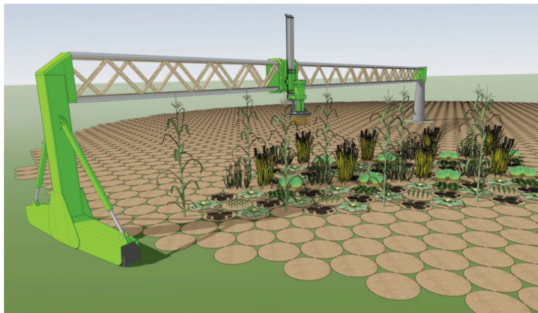
In etwa so könnte der Roboter für Markus Buchers Landwirtschaftsfläche einmal aussehen. Am Werkzeugträger in der Mitte sollen verschiedene Werkzeuge zum Säen, für die Bodenbearbeitung aber auch zum Ernten angehängt werden können. ZVG/HONESTA/SEMESIS
